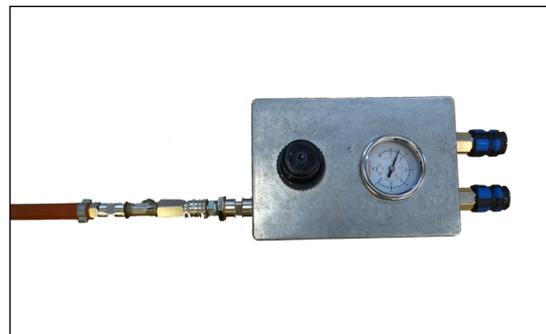
Das Ventil des Verteilers muss in geschlossener Position sein, bis alle Druckschläuche verbunden sind.
