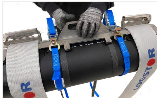
Das Rückschlagventil in den drei Druckbändern mit einem stumpfen Werkzeug auslösen.
